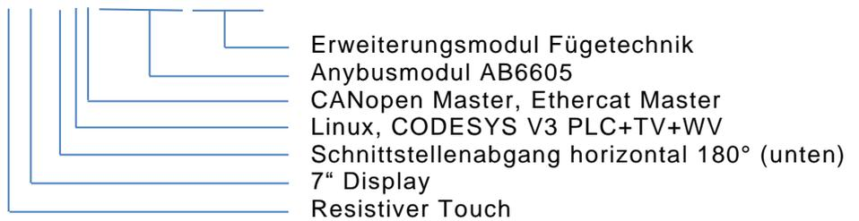
z.B. smart9 1000 CP mit 10" Display, Schnittstellenabgang vertikal 90°, kapazitiver Touch, Linux, CODESYS V3 PLC Target Visu + WebVisu, CANopen Master + Ethercat Master, kein Anybus-Modul
